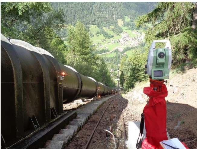
Mesures d'une conduite forcée
